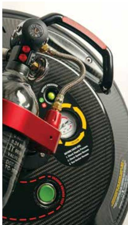
Si, por algún motivo, se produce una avería en el suministro de aire o nitrógeno que utiliza el WinGrip todo en uno, se oirá una alarma y el anclaje de vacío conservará el vacío para que el trabajador continúe estando seguro durante al menos 20 minutos.
